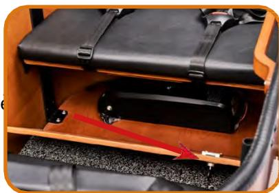
2. Desserrez la batterie à l'aide de la clé sur le côté gauche
